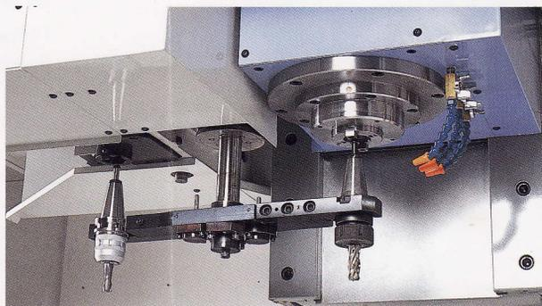
ランダムアクセス機能とサーボ駆動のツールマガジン(24本収納)の組合せにより、1.2sec高速ツールチェンジを実現します。
