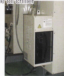
7 主轴冷却装置 Spindle oil chiller
